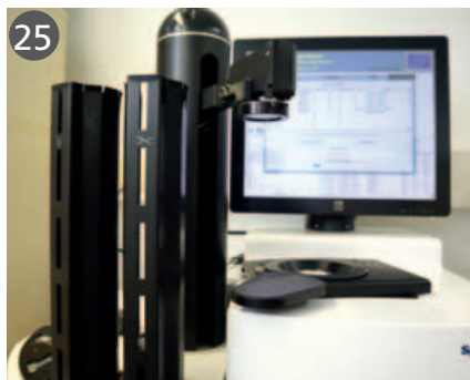
Der Probenehmer setzt die Probe automatisch auf den Messträger
