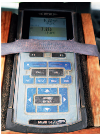
Mit dem Messgerät wird die Wasserqualität bestimmt
