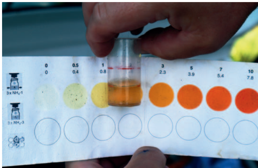
Mithilfe einer Farbskala bestimmt Sven Weichenberger den Ammoniumgehalt des Wassers
